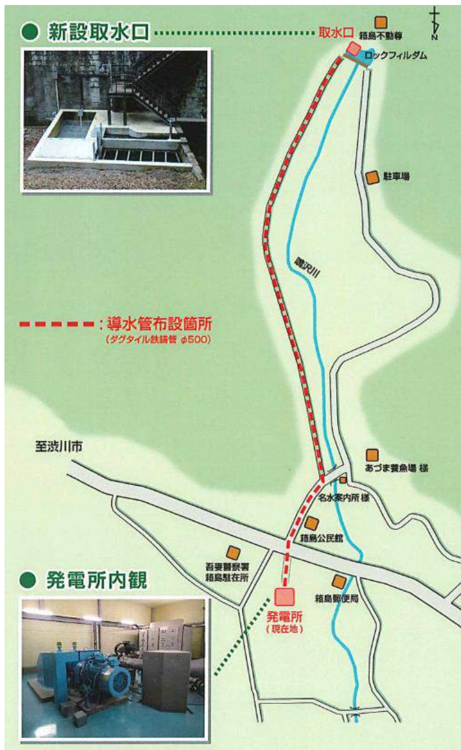
図6◇箱島湧水発電所の所在地と設備。出典：NPO 法人環境技術研究所
