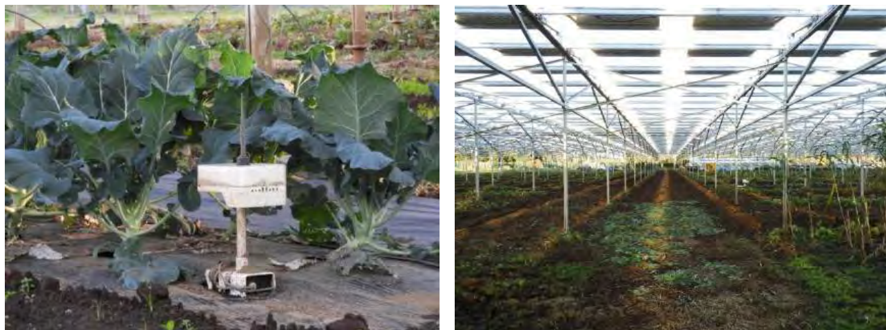
写真 3-2 ブロッコリー畑の気象センサー(左)、からし菜畑の支柱に設置した LED 補光設備(右)
