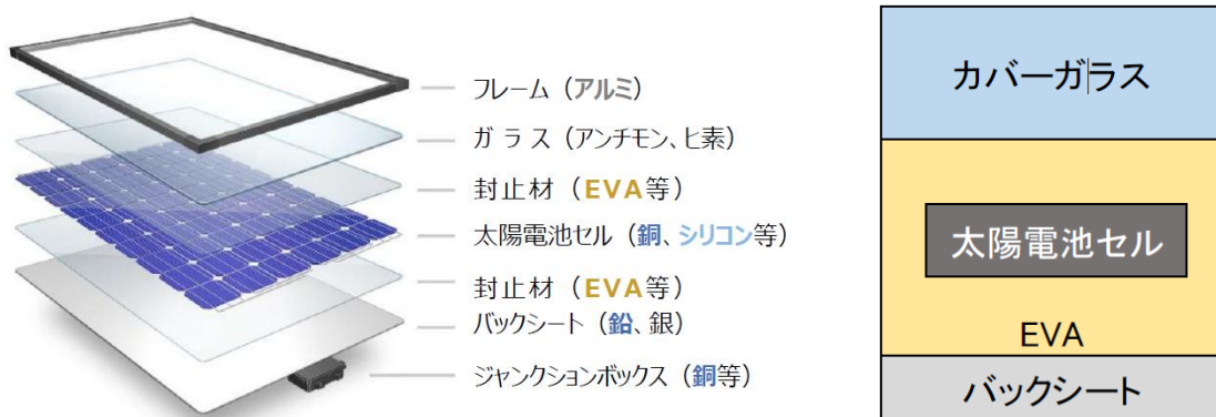
図 2 太陽光パネルの構造(左)と断面図(右)
