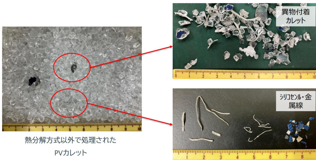
写真 1 太陽光パネルのガラスくず(ガラスカレット)に含まれる異物の様子
