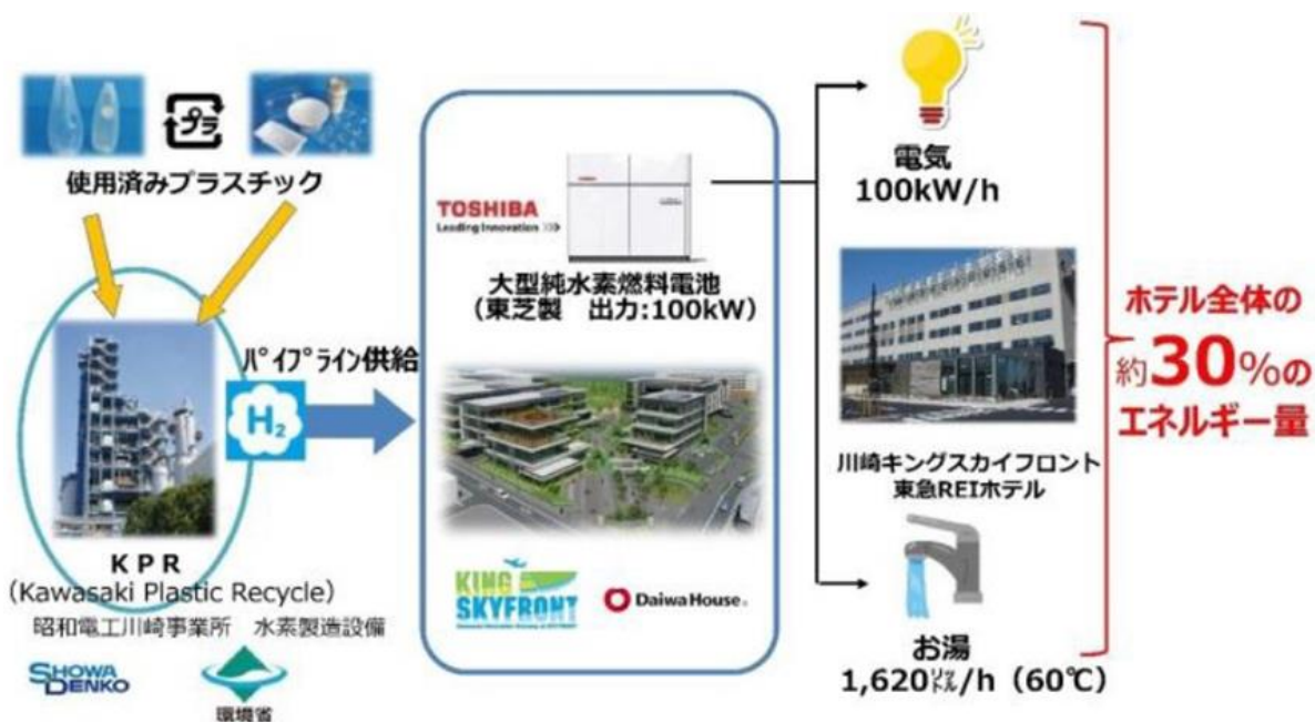
図 6. 燃料電池による電力と温水の供給。出典：大和ハウス工業、東急ホテルズ、川崎市
