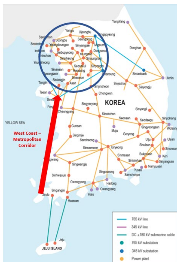
図14:韓国の送電系統と新しい高圧直流送電線
